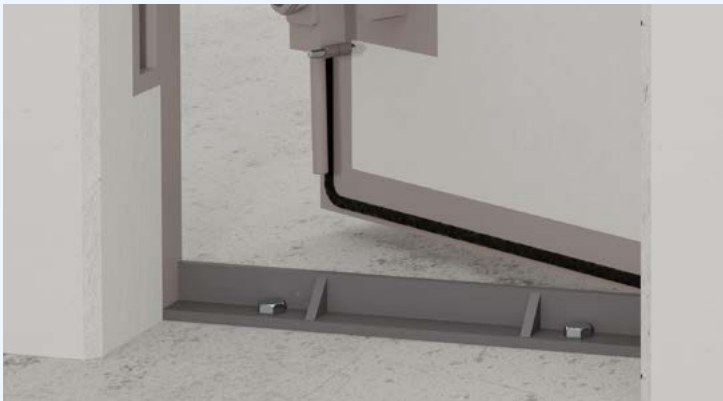
Abb. 5a/5b Für eine bessere Zugänglichkeit im Alltag wurden manche Schutzräume ohne Schwelle erstellt. Sie verfügen über eine demontierbare Schwelle, etwa an der Panzertüre befestigt, die beim Vorbereiten am Boden festgeschraubt wird.
